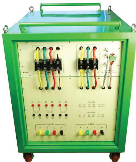
RVT1206 继电保护向量检查装置后面板
